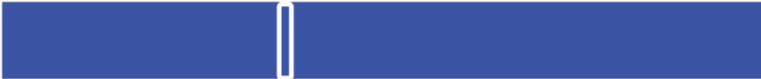
Рис. 2.7 Ползунок (теперь он синий, и рукоятка сдвинута влево), на который влияют атрибуты value и color
