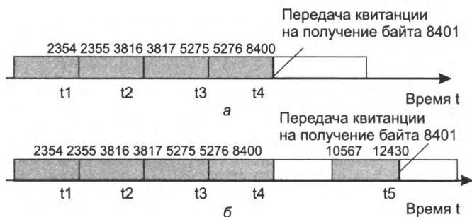
Рис. 15.19. Накопительный принцип квитирования: а — плотное заполнение буфера (в момент t_4 передается квитанция на байт 8401), б — неплотное заполнение буфера (в момент t_5 снова передается квитанция на байт 8401)
