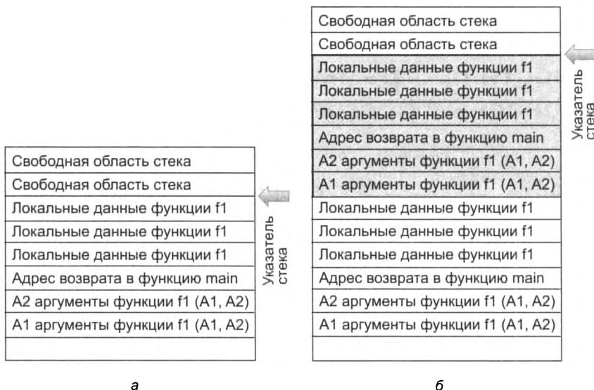
Рис. 30.1. а — структура стека до вызова функции f_2 из функции f_1 ; б — структура стека после вызова функции f_2 из функции f_1
