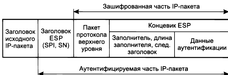
Рис. 29.17. Структура IP-пакета, обработанного протоколом ESP в транспортном режиме
