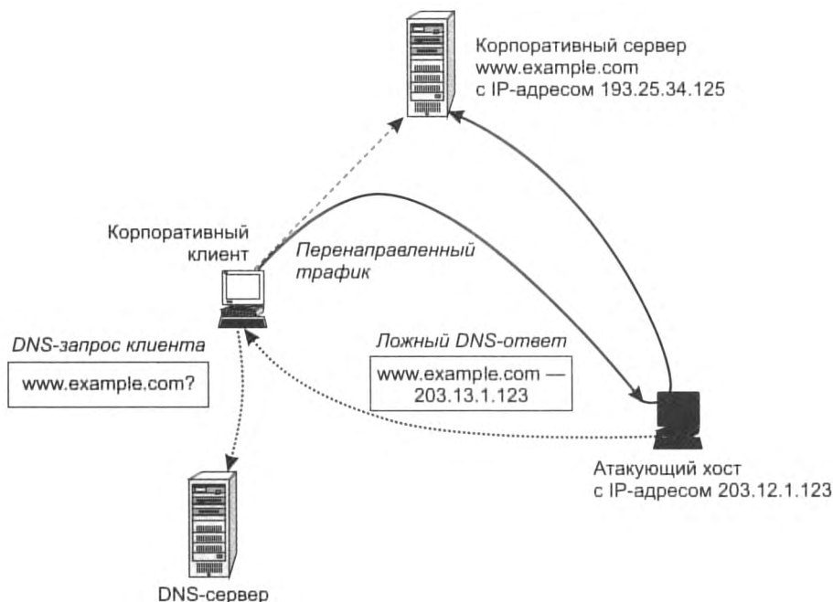
Рис. 29.5. Схема перенаправления трафика путем использования ложных DNS-ответов
