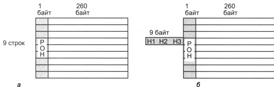
Рис. 8.15. Виртуальный контейнер VC-4 (а) и его блок AU-4 (б)
