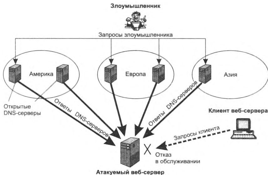
Рис. 29.6. Атака отражением от DNS- серверов
