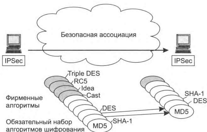
Рис. 29.11. Согласование параметров в протоколе ESP
