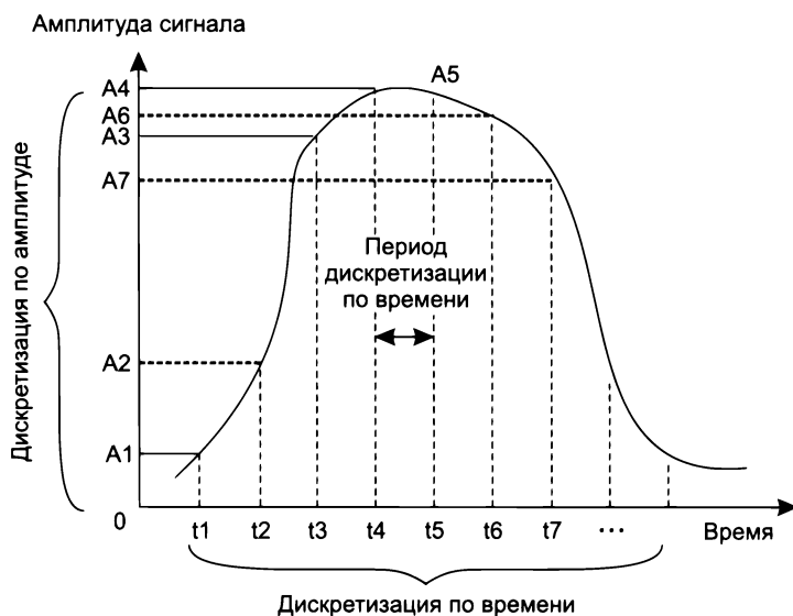
Рис. 3.1. Дискретная модуляция непрерывного процесса
