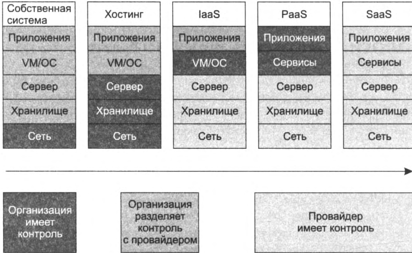
Рис. 18.9. Распределение контроля и ответственности между провайдером и клиентом в разных моделях облачных сервисов
