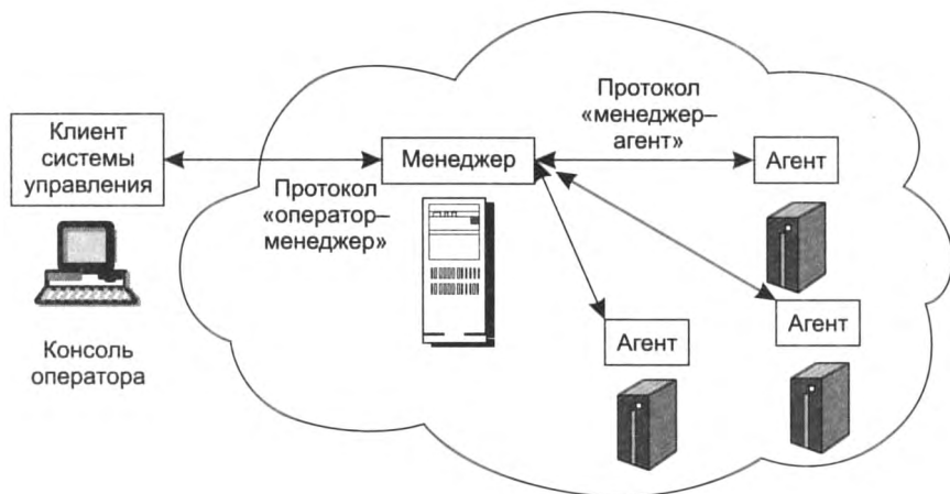
Рис. 25.2. Трехзвенная схема управления сетью
