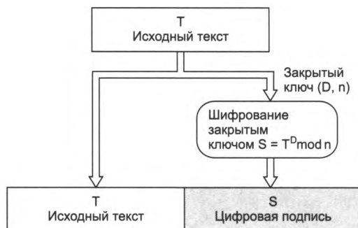
Рис. 27.6. Схема формирования цифровой подписи по алгоритму RSA
