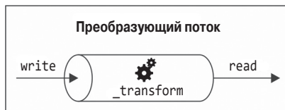
Рис. 5.5 ❖ Схема работы преобразующего потока
