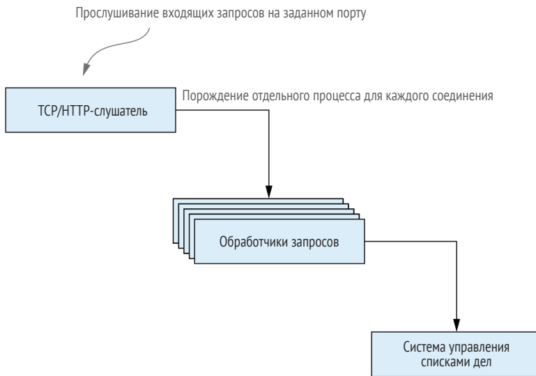
Рис. 11.2 ❖ Обработка запросов в отдельных процессах
