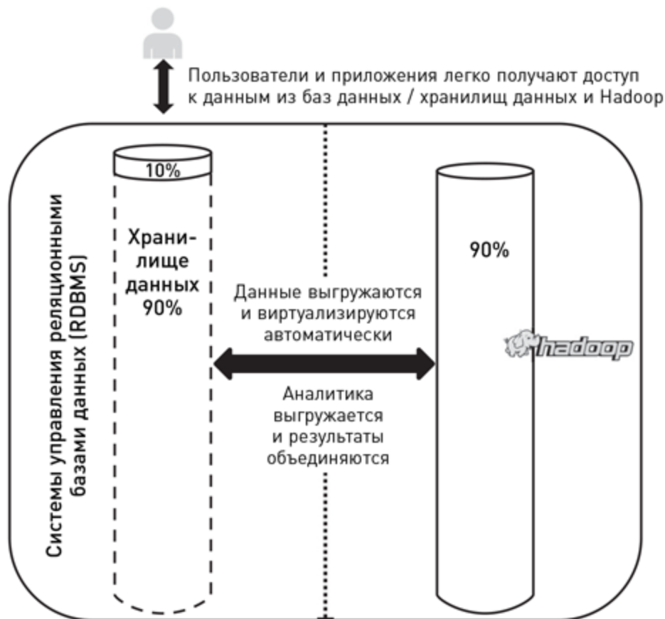
Рис. 8. Совместная работа баз данных, хранилища данных и Hadoop (на основе рисунка из официальных документов к платформе данных Gluent, 2017*).
